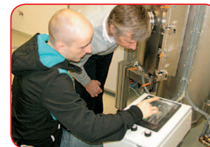
Příprava elektronové pece k tavení wolframu
