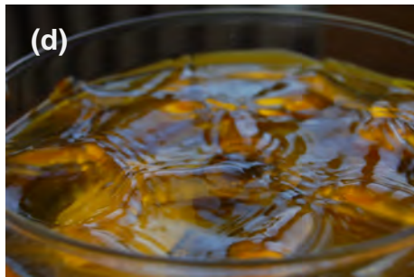
Obrázek 9.8: Povrch vody při maximální amplitudě vibrací pro frekvence (a) 3 Hz, (b) 4,125 Hz, (c) 7,25 Hz a (d) 9 Hz. [Zdroj: archiv týmu]
