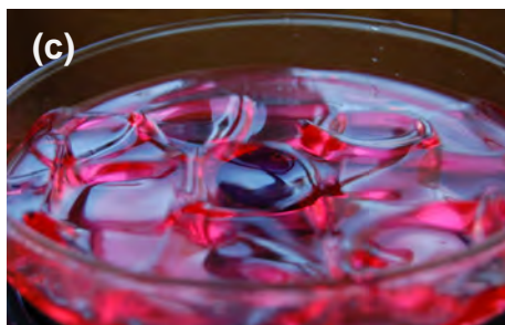
Obrázek 9.10: Povrch glycerolu při maximální amplitudě vibrací pro frekvence (a) 8,625 Hz, (b) 10,25 Hz a (c) 10,75 Hz [Zdroj: archiv týmu]
