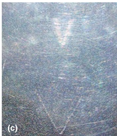
Obrázek 10.15: (a), (b) Detail vnitřní (a) jemného a (b) hrubého vrypu (zvětšení 150×). (c) Jemné vrypy vedou k dobře pozorovatelnému hologramu, zatímco (d) hrubé vrypy prakticky znemožňují pozorování. Při experimentech byly přitom zachovány všechny ostatní relevantní parametry, tj. všechny kromě hrubosti vrypů.
