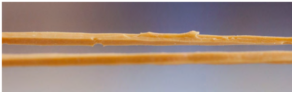
Obrázek 8.9: Trvale poškozená gumička s poškozenou strukturou a přetrhanými vazbami (zpravidla na hranách)
