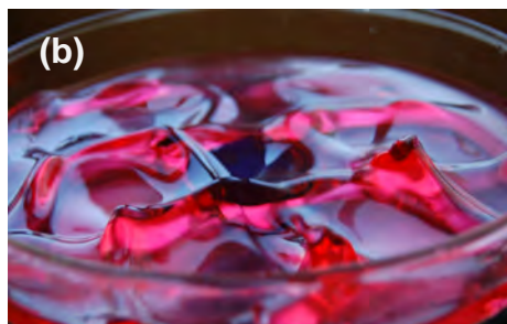
Obrázek 9.10: Povrch glycerolu při maximální amplitudě vibrací pro frekvence (a) 8,625 Hz, (b) 10,25 Hz a (c) 10,75 Hz [Zdroj: archiv týmu]
