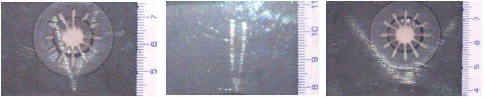
Obrázek 10.6: 2D hologram písmena „V” (a) podle schématu na obr. 10.4a, (b) podle schématu na obr. 10.4b, (c) podle schématu na obr. 10.5. Panely (a) a (b) se liší pouze poloměrem vrypů, v panelech (a) a (c) je použité pouze jiné umístění zdroje světla; ostatní relevantní parametry jako poloha destičky vůči fotoaparátu apod. jsou s dostatečnou přesností zachovány.
