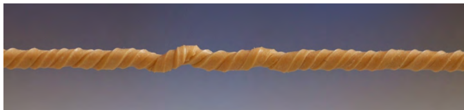
Obrázek 8.5: Začínající vlnění na primárním vinutí (náznak vzniku sekundárního vinutí („očka“)).
