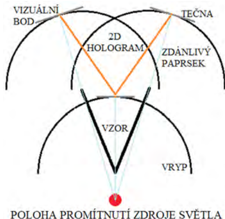
Obrázek 10.5: Geometrické řešení pro zvětšený hologram
