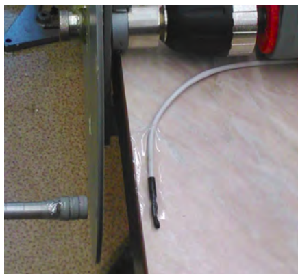
Obrázek 12.3: Experimentální uspořádání pro zkoumání vlivu tloušťky vodiče. Magnet (vlevo) je připevněn na hliníkovém kotouči (uprostřed), který je roztáčen elektrickou vrtačkou.
