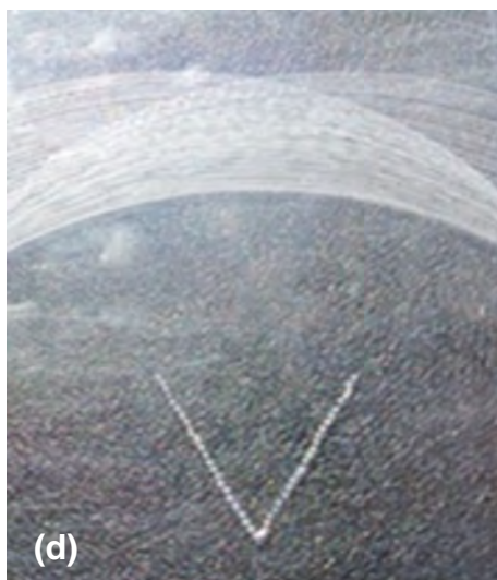
Obrázek 10.15: (a), (b) Detail vnitřní (a) jemného a (b) hrubého vrypu (zvětšení 150×). (c) Jemné vrypy vedou k dobře pozorovatelnému hologramu, zatímco (d) hrubé vrypy prakticky znemožňují pozorování. Při experimentech byly přitom zachovány všechny ostatní relevantní parametry, tj. všechny kromě hrubosti vrypů.
