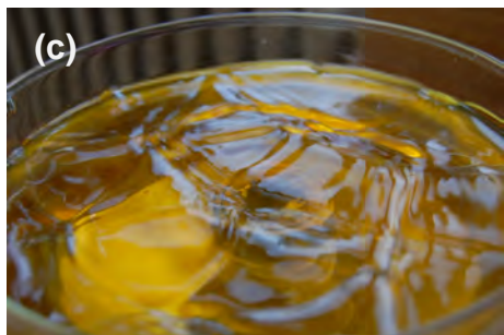
Obrázek 9.8: Povrch vody při maximální amplitudě vibrací pro frekvence (a) 3 Hz, (b) 4,125 Hz, (c) 7,25 Hz a (d) 9 Hz. [Zdroj: archiv týmu]
