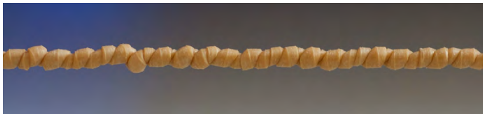
Obrázek 8.7: Dokončené sekundární vinutí. Při dalším točení se toto vinutí zhušťuje a narůstá napětí v krutu, a proto se opět začíná gumička vlnit (viz další obrázek).
