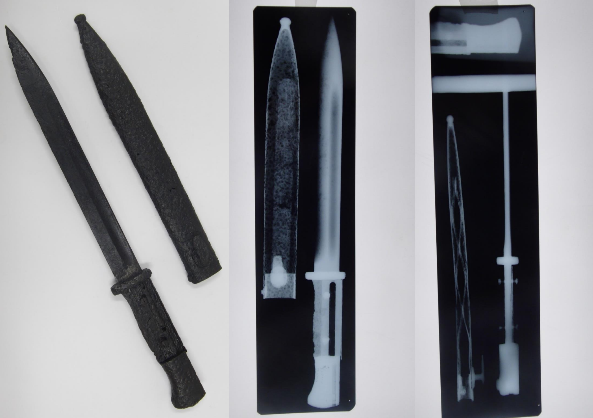
Materiálový průzkum – radiografie (německý bodák, 1935)
